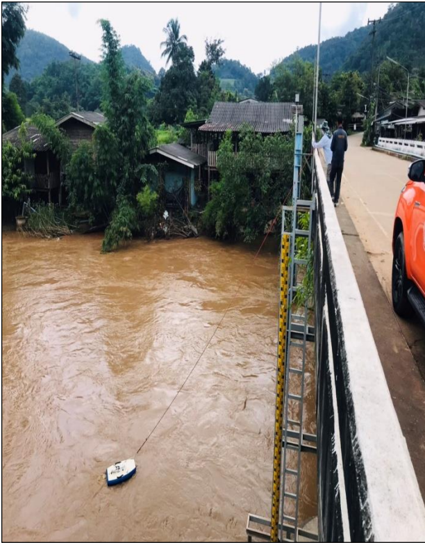
รูปที่ 5-7 ทำการสำรวจปริมาณน้ำและการสำรวจตะกอนแขวนลอยสถานี P.92 น้ำแม่แตง บ้านเมืองกุด อ.แม่แตง จ.เชียงใหม่
