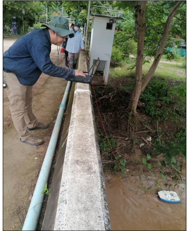
รูปที่ 5-7 ทำการสำรวจปริมาณน้ำและการสำรวจตะกอนแขวนลอยสถานี P.92 น้ำแม่แตง บ้านเมืองกุด อ.แม่แตง จ.เชียงใหม่
